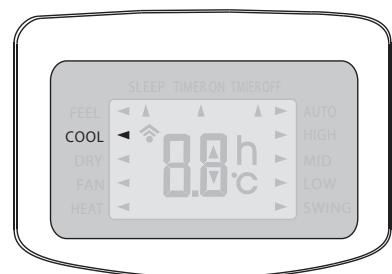
Установите скорость вентилятора кнопкой FAN и направление воздушного потока кнопкой SWING.
