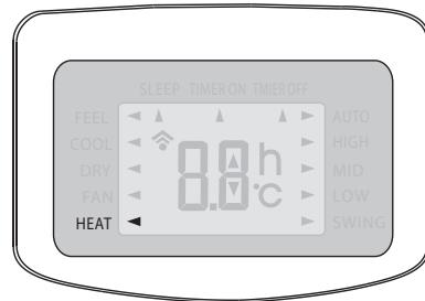
В кондиционере имеется функция «горячий пуск». При включении в режим нагрева вентилятор внутреннего блока включается в работу с задержкой в несколько секунд, с целью предотвращения подачи холодного воздуха в помещение.
