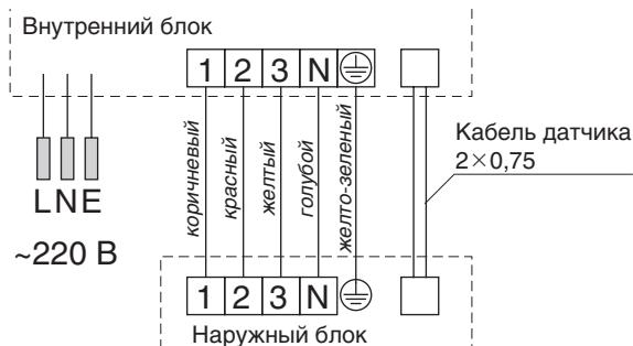
9.2 Схемы электрические блоков.
