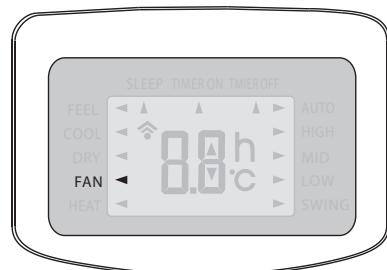
В автоматическом режиме вентилятора скорость определяется автоматически в зависимости от разницы между заданной и фактической температурой. Чем больше разница, тем выше скорость.
