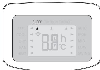
После второго часа работы температура поднимается еще на 1 °C. Далее при работе заданная температура не изменяется.
